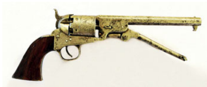
Colt Navy 1851 s odklopenou nabíjecí pákou. Pohybem páky dolů zasunoval střelec při nabíjení kulku do bubínku revolveru.
